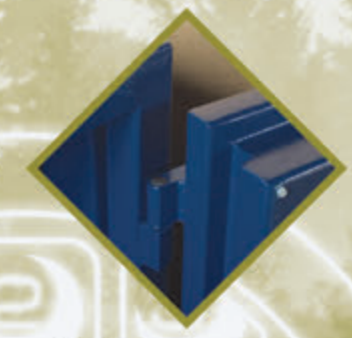
Double condamnation par 5 pènes et par emboîtement anti-arrachement de la porte sur toute sa hauteur.
